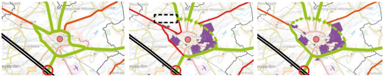
Figuur 19: Wegencategorisering stad Tienen: korte termijn, lange termijn zonder en met realisatie van het noordwestelijke deel van de rondweg tussen de N3 en de N223.
